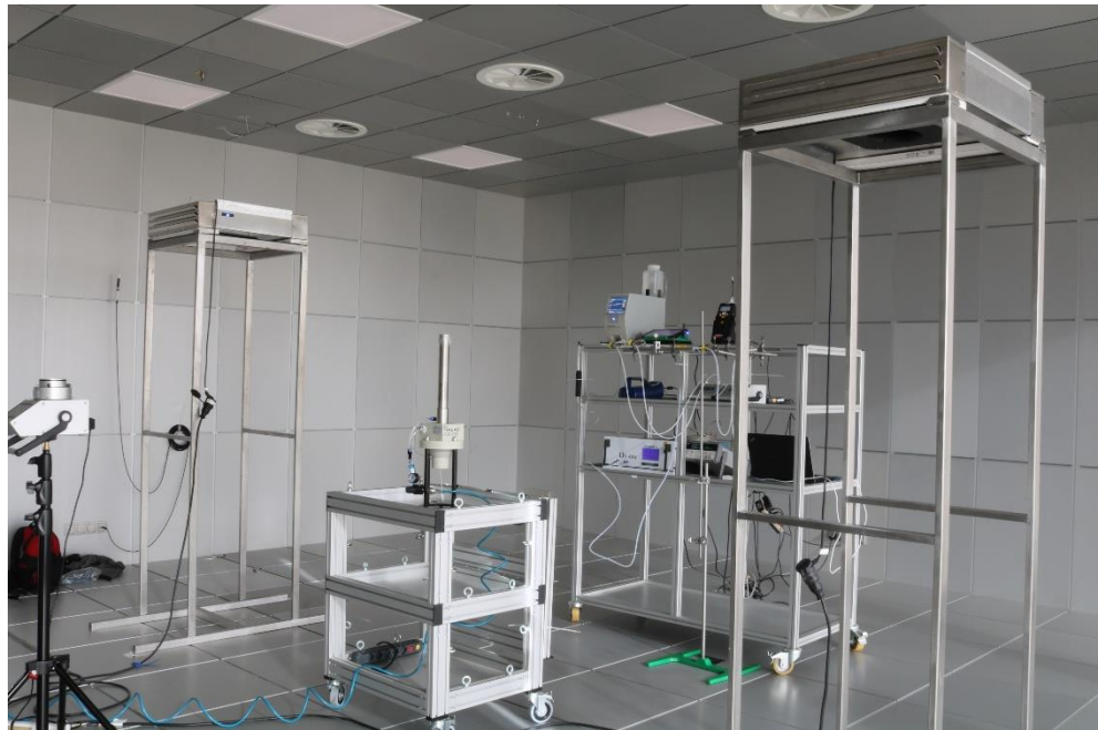
Bild 2: Aufbau der Cleanair Sky L-Luftreinigungsgeräte im HiPIE-Labor mit Dosiergerät und Luftkeimsammler.
